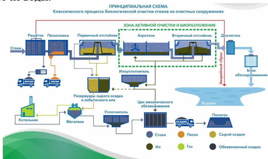
Рисунок 2 – Принципиальная схема классического процесса биологической очистки стоков
