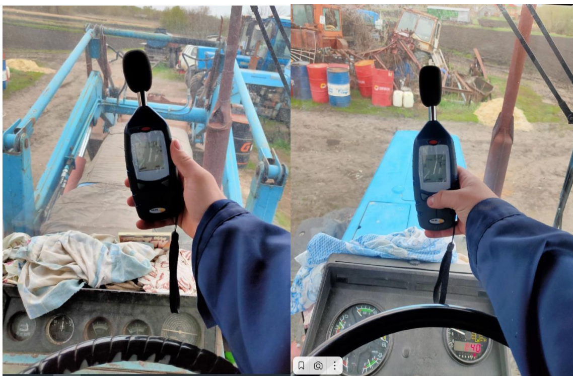
Рисунок 2 – Замер уровня шума в кабине трактора МТЗ-1221 с помощью прибора Testo 816.
