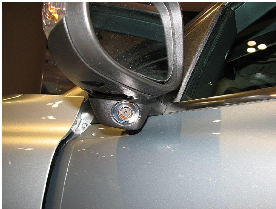
Рисунок 3 – Оптический датчик слепых зон на боковых зеркалах
